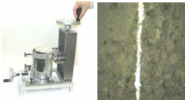
写真 1 引っかかり試験装置および引っかかり傷の一例
