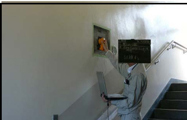
写真No. 4 (写真向き ↑) 引っかけ傷法 壁 『測ってみタロー』による引っかけ傷幅測定状況
